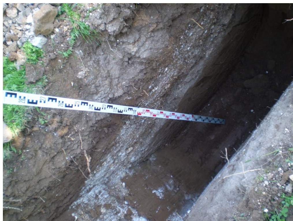
Foto 4: Scavo geognostico T4 (profondità 2,70 m)
