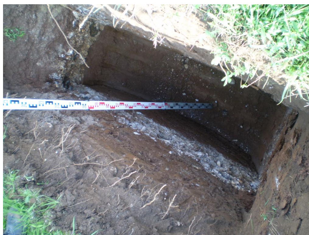
Foto 3: Scavo geognostico T3 (profondità 2,50 m)
