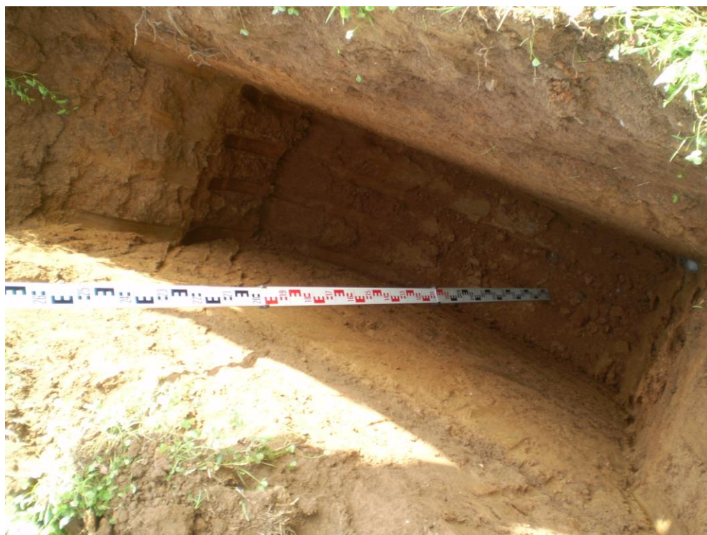
Foto 5: Scavo geognostico T5 (profondità 2,60 m)
