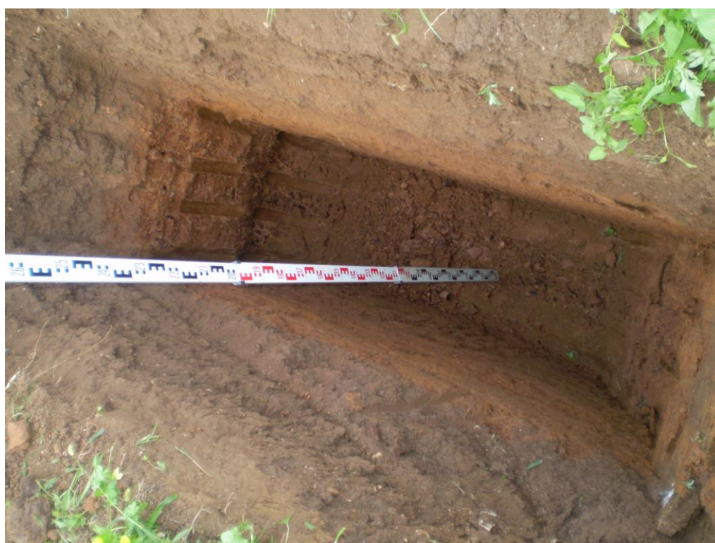
Foto 1: Scavo geognostico T1 (profondità 2,50 m)
