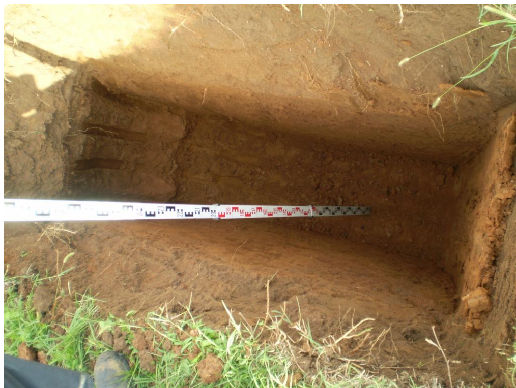
Foto 2: Scavo geognostico T2 (profondità 2,60 m)
